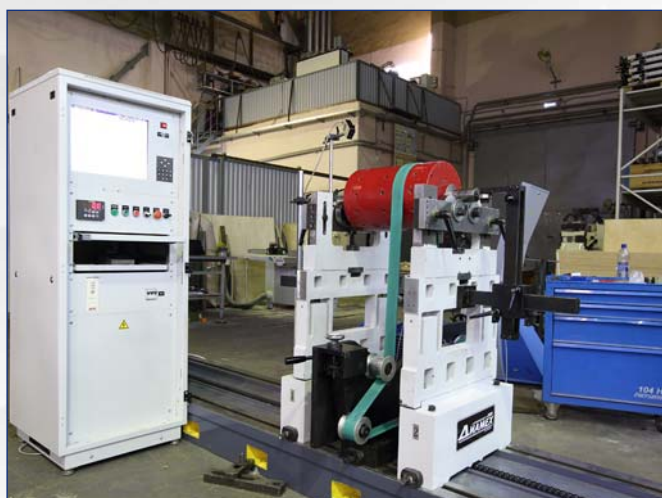
Дорезонансный балансировочный станок, изготовленный совместно с компанией Атис-Баланс
